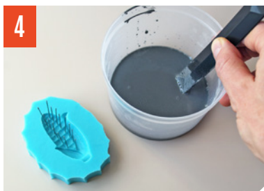
4 Insert sewing needles for air vents, then pour the aluminum-filled epoxy.
